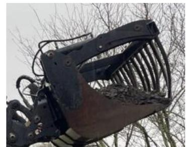
Chargement du godet avec des pierres pour faciliter l'enfoncement des piquets
